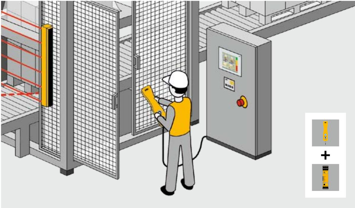
La solution optimale : surveillance d'une commande bimanuelle avec l'organe de commande manuelle PITjog et le bloc logique de sécurité PNOZ s6.
