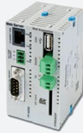
Le FP Web Server permet entre autres la centralisation et la récupération des données des compteurs Eco Power Meters.
