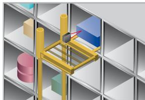
**Nota :** La différence de portée est de 5% maxi. entre du papier blanc non brillant et du papier gris non brillant avec une luminosité de 5, à une distance de détection de 2m. [EQ-5M1(T)]
