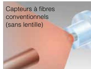
Capteurs à fibres conventionnels (sans lentille)
