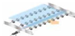
Cet équipement antistatique peut être installé dans des endroits inaccessibles aux barres ionisantes conventionnelles. Placé plus près de l'objet, il offre une neutralisation plus précise.
