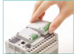
Démontable facilement (deux vis pour fixer la cassette)
