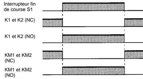
S1 : Interrupteur de sécurité fin de course avec mécanisme d'ouverture positif (D4D et D4B)
