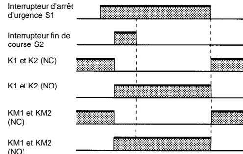
S1: Interrupteur d'arrêt d'urgence avec mécanisme d'ouverture positif
