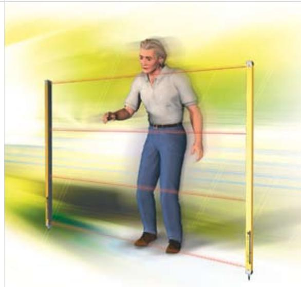
▲ Masquage flottant : cette fonction désactive la détection de 1, 2 ou 3 faisceaux non spécifiques. Elle convient parfaitement lorsqu'une pièce de fabrication doit traverser la zone de détection de manière répétée, par exemple.
