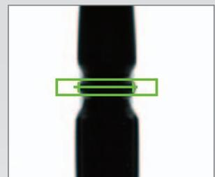
Cet élément d'inspection mesure la largeur entre les contours.
