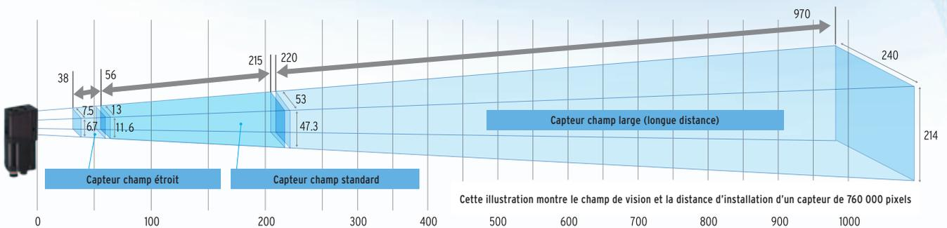
Une caméra à angle de vision latéral large prend des images et effectue des inspections sur une vaste zone, même lorsque cette caméra est proche de la pièce.
