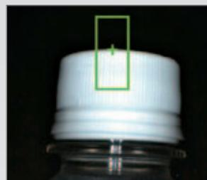
Cet élément d'inspection détecte les contours et mesure leurs positions.
