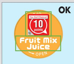
La position correcte d'une pièce ayant une orientation incohérente peut être mesurée via la détection automatique du décalage de la pièce par rapport au modèle standard enregistré.
