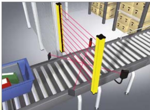
Système d'occultation dans un entrepôt automatisé pour l'approvisionnement du matériel en production.
