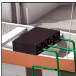
Un seul gestionnaire MRP contrôle la boucle redondante conforme à PROFINET.
