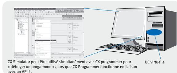
CX-Simulator peut être utilisé simultanément avec CX programmer pour « déboguer un programme » alors que CX-Programmer fonctionne en liaison avec un API !
