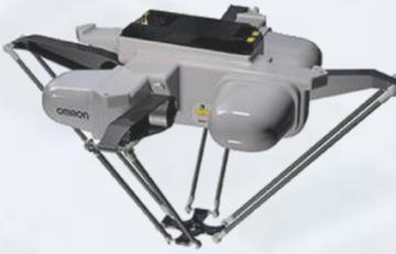
**iX4** - 4 axes, vitesse élevée et une haute précision, 15kg
