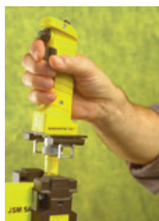
Poignée JSHD4 montée sur une unité de commande de machine.
