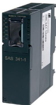
SAS 341 est un module de communication série utilisé dans les systèmes S7. SAS 341 permet la liaison à l'API d'appareils série tels que lecteurs de codes à barres, terminaux d'opérateur, imprimantes en série, ordinateurs personnels, automates d'autres fabricants. Il supporte les protocoles ASCII, 3964R et RK512.
