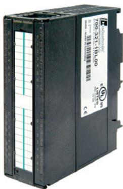
Les modules E/S numériques convertissent les signaux binaires externes émanant du processus en signaux internes à l'automate programmable. Des DEL vertes indiquent l'état des signaux E/S. Les modules E/S de Systeme Helmholtz GmbH peuvent également servir à la connexion de détecteurs de proximité 2 fils.
