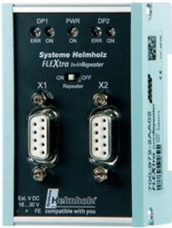
Malgré sa taille compacte, le nouveau répéteur FLEXtra® twinRepeater présente toutes les fonctions d'un répéteur PROFIBUS. Il est conçu pour un montage sur rail DIN. Le FLEXtra® twinRepeater régénère le signal électrique arrivant sur le bus et le retransmet (remise en forme et retransmission des bits).
