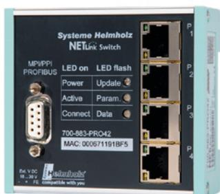
NETLink® Switch est une passerelle PROFIBUS-Ethernet 4 ports. Elle peut être utilisée pour programmer, configurer, visualiser et utiliser à distance des automates S7. Elle est conçue pour un montage sur rail DIN. Elle est soit intégrée au bus via connecteur PROFIBUS, soit enfichée directement dans l'interface MPI, PPI ou PROFIBUS d'une unité de bus au moyen d'un câble actif enfichable.
