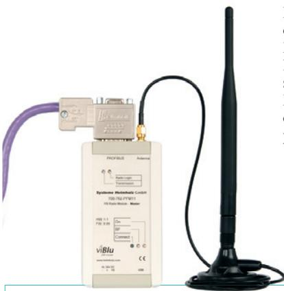
Le système radio PROFIBUS viBlu est une liaison câble virtuelle qui permet de relier par radio des E/S ou des composants intelligents distribués. La transmission est réalisée par Bluetooth et supporte des vitesses de 1,5 Mbit/s maximum. En fonction des conditions locales, des distances de transmission de 100 m maximum sont possibles.
