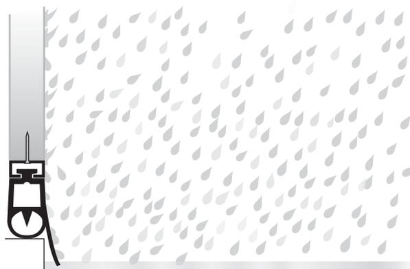
Le Safedge peut également être commandé avec un capot en caoutchouc, comme illustré ci-dessous. Cela permet la compression du capuchon de caoutchouc sans déformation du profilé.
