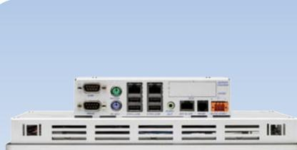
Port Ethernet simple/double, de un à quatre ports USB, un port RS485, équipent en standard tous les modèles, offrant de nombreuses possibilités de connexions à différents périphériques d'automatisation.
