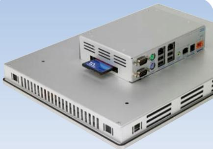
L'adoption de mémoires de masse du type Compact Flash et/ou DiskOnModule, et leur retrait / remplacement "à chaud", sont gages d'une sécurité intrinsèque, d'une fiabilité et d'une robustesse élevées.
