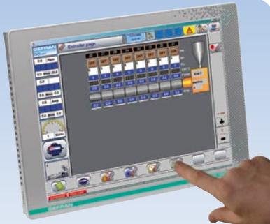
Tous les modèles sont proposés avec écran tactile de type résistif à quatre fils, écran TFT couleur. En option, les modèles de 6,5" et de 10,4" sont proposés avec clavier intégré.
