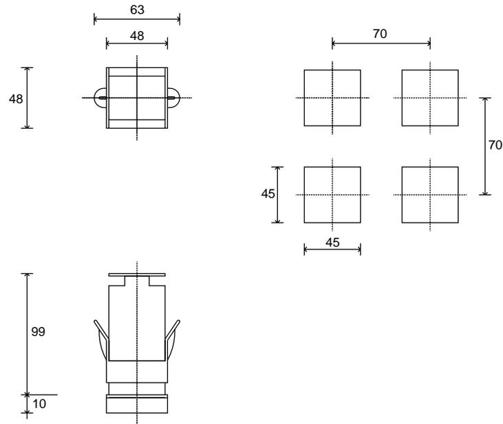
Dimensions d'encombrement: 48 x 48 mm (1/16 DIN) profondeur 99 mm
