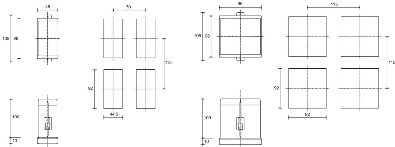
Dimensions hors-tout: 48x96mm - 96x96mm (1/8DIN - 1/4DIN) profondeur 100mm
