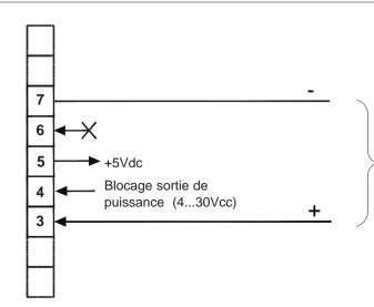
Entrée numérique à cycle variable (fréquence porteuse 500Hz - 10kHz, maxi 24Vcc)
