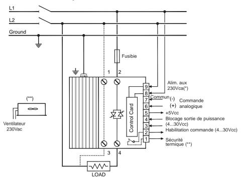
Modèles avec alimentation auxiliaire > 230Vca (par exemple: sigle W312...030, alimentation auxiliaire 400Vca)
