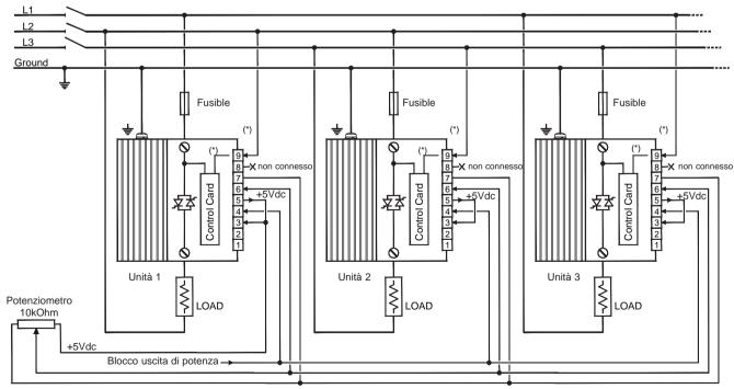
(\*) Alimentation auxiliaire 400Vca + 10%-20%-50 Hz pour la carte de commande (indiquée dans le sigle et sur l'étiquette) : elle doit être en phase (synchronisée) avec la tension appliquée à la charge.
