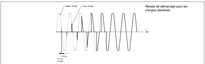
**DT** - "Delay triggering" Retard d'amorçage du premier cycle (uniquement pour les modalités de commande ZC, BF) monophase Programmable entre 0° et 90°.
