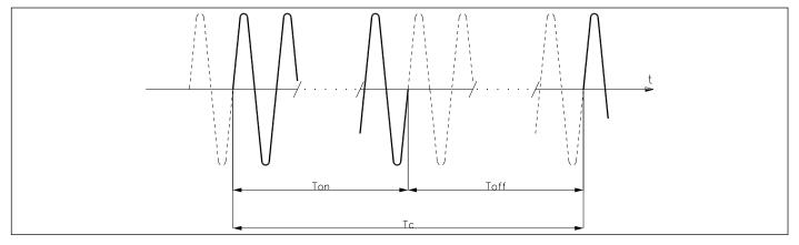
**BF** - Burst Firing, Zero Crossing avec temps de cycle variable (GTT) (monophase ou biphase).
