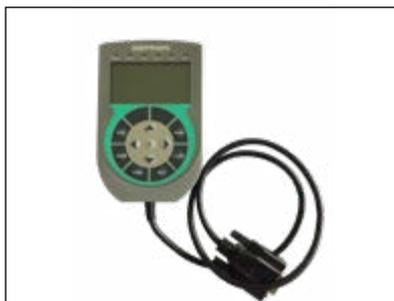
L'interface homme/machine est simple, immédiate et hautement fonctionnelle, grâce au clavier de programmation GPC – OP (en option), permettant de lire et d'écrire tous les paramètres d'un module. Le clavier est raccordé via un connecteur D-SUB 9 pôles et il s'installe sur la façade du GPC-M, grâce à une plaque magnétique.
