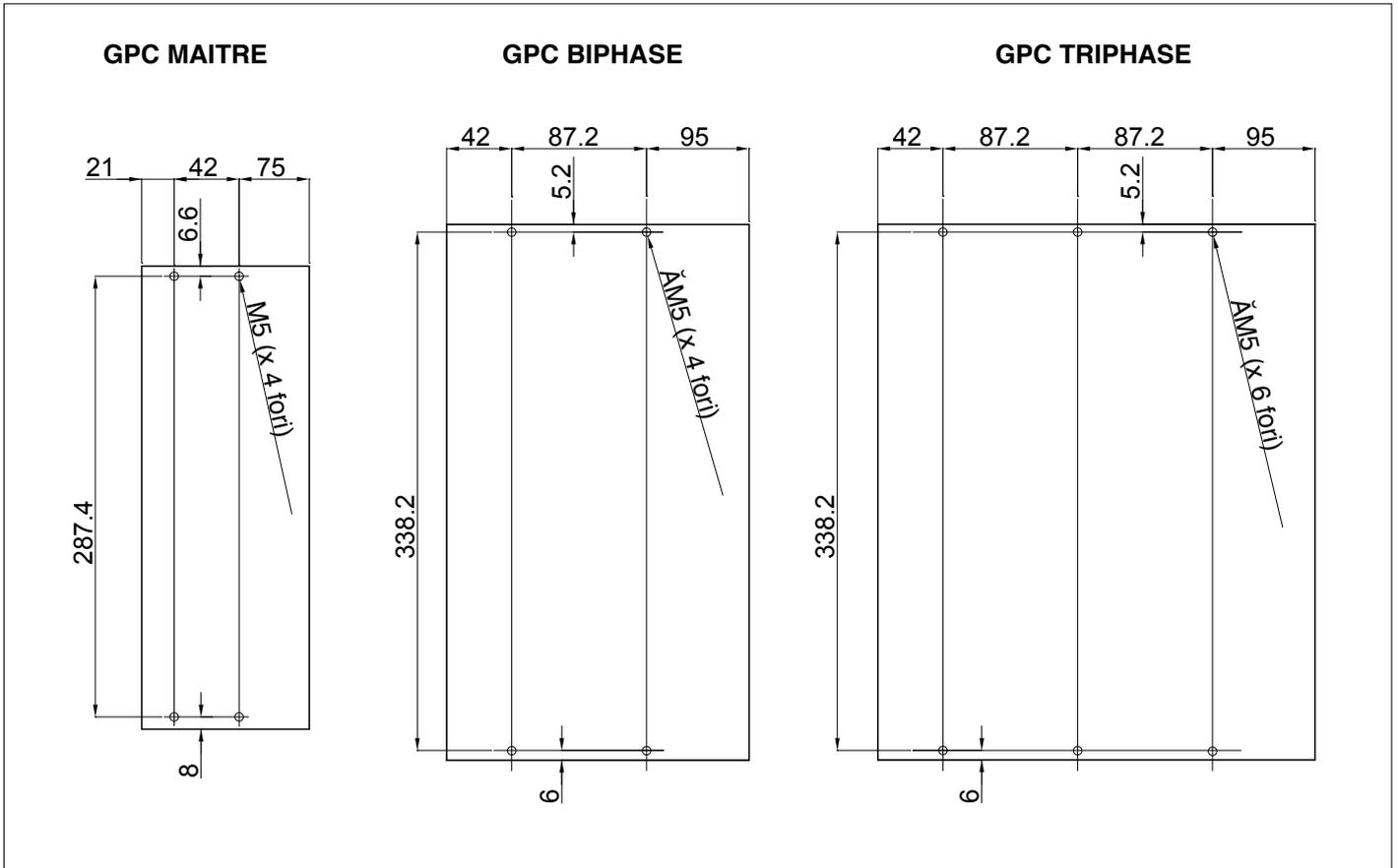
La fixation peut s'effectuer à l'aide de vis (M5). Toutes les dimensions sont exprimées en mm.
