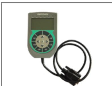
L'interface homme/machine est simple, immédiate et hautement fonctionnelle, grâce au clavier de programmation GFW – OP (en option), permettant de lire et d'écrire tous les paramètres d'un module. Le clavier est raccordé via un connecteur D-SUB 9 pôles et il s'installe sur la façade du GFW-M, grâce à une plaque magnétique.
