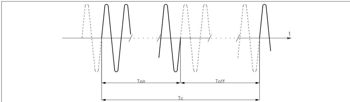
**BF - Burst Firing, Zero Crossing** avec temps de cycle variable (GTT) Cette modalité gère la puissance sur la charge au travers d’une série de cycles de conduction ON et de non conduction OFF. Le rapport entre le nombre de cycles ON et OFF est proportionnel à la valeur de la puissance à transférer vers la charge.
