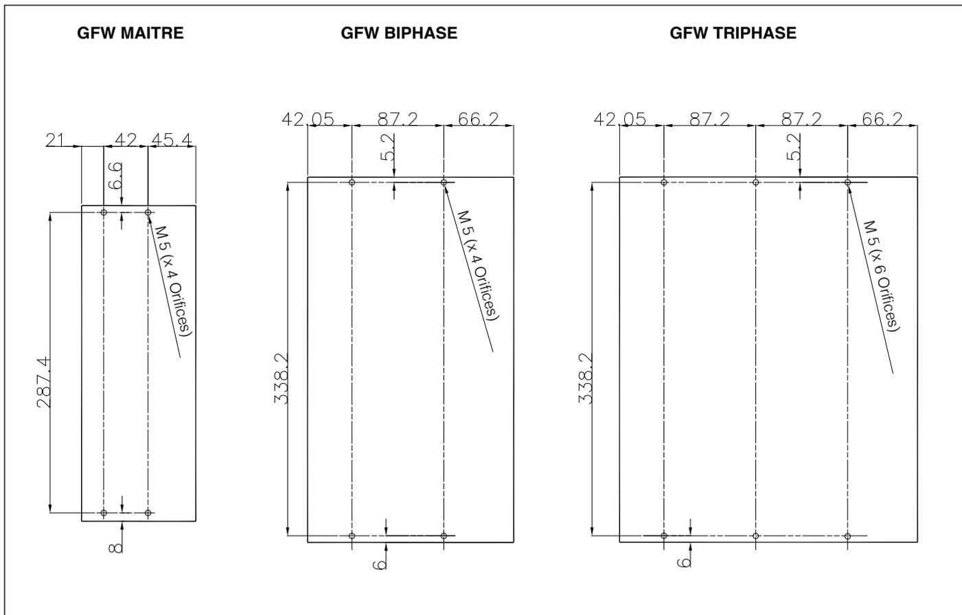
La fixation peut s'effectuer à l'aide de vis (M5). Toutes les dimensions sont exprimées en mm.
