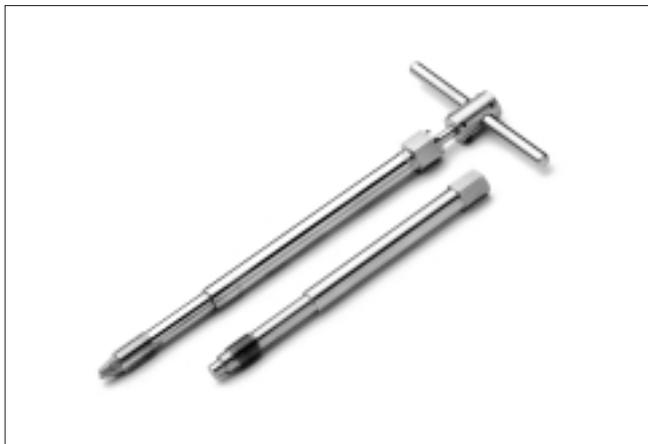
Le Kit outil de nettoyage est utilisé pour éliminer le surplus de matière plastique dans les orifices de montage des transducteurs, avant de procéder à leur installation. L'installation des transducteurs dans des orifices de montage bouchés et/ou encrassés constitue l'une des causes principales d'endommagement. Ce Kit assure un nettoyage adéquat de l'orifice de montage et permet d'en vérifier l'intégrité.
