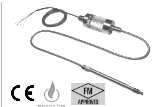
Le groupe amplificateur/capteur d'un transmetteur de pression de melt de la série WF est livré dans un boîtier en acier inoxydable soudé, avec un câble auxiliaire conduit. Ce boîtier métallique est parfaitement étanche aux agents atmosphériques et répond aux exigences pour les zones dangereuses.
