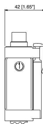
La fonction Autozéro est activée par le biais d'un contact magnétique (aimant extérieur livré avec le capteur). Pour la description complète de la fonction Autozéro, se reporter au manuel opérateur.
