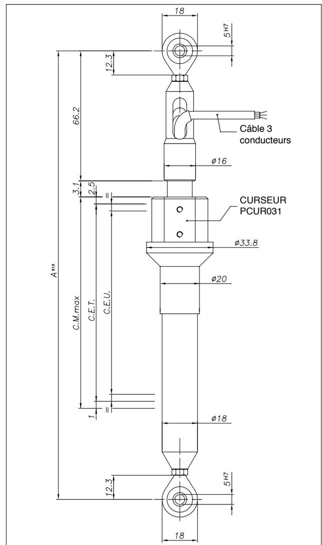
**Important:** toutes les données fournies dans le catalogue pour les valeurs de linéarité et les coefficients de température sont valables pour l'utilisation du capteur comme diviseur de tension avec un courant maximum circulant dans le circuit I<sub>c</sub> < 0.1µA
