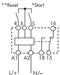
\* Les bornes R, S, et X ne doivent pas être raccordées à alimentation. La borne X est au même potentiel que l'alimentation, "Delta U" entre S,X,R est <10Volts.
