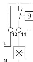
**Contrôle du chauffage** - Lorsque la température de l'armoire chute au dessous de la valeur minimale sélectionnée, le contact se fermera pour demander du chauffage. Le contact s'ouvrira lorsque la température dépassera la valeur sélectionnée.
