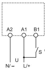
\* Avec une alimentation DC, le signal de commande (S) sera raccorder en B1 au pôle positif selon EN (60204-1).
