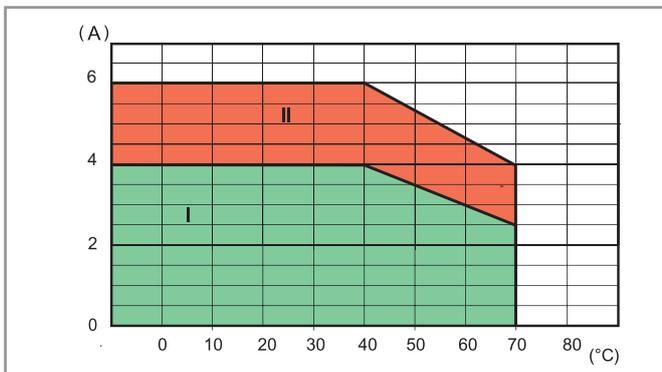
**I:** relais installés côte à côte (sans espace entre les supports) avec module fusible inséré
