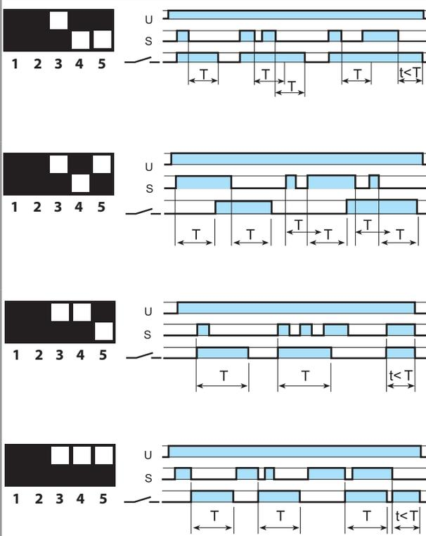
**(BE) Temporisé à la coupure avec signal de commande**
