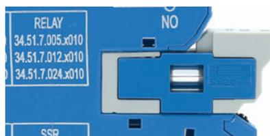
2. Si le module fusible est extrait (par exemple, lorsque le fusible est fondu), le circuit de sortie est verrouillé en position ouverte, correspondant à un état "sécurité".
