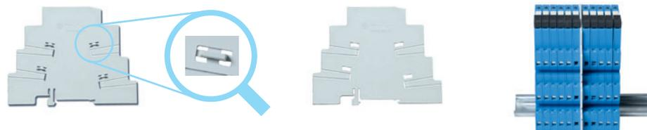
2. Le maintien des protubérances permet une séparation de 6.2 mm. En coupant simplement (avec un ciseau) le segment correspondant, on permet le raccordement au travers du séparateur de 2 groupes d'interface relais, en utilisant le peigne standard.
