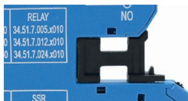
1. Lorsque le module fusible est inséré, après avoir retiré l'accessoire de connexion (pièce en plastique noire), le fusible est en série électriquement avec la borne de sortie de l'interface relais (11 pour les versions EMR, 13 pour les versions SSR, 15 pour le timer EMR, 15+ pour le timer SSR)
