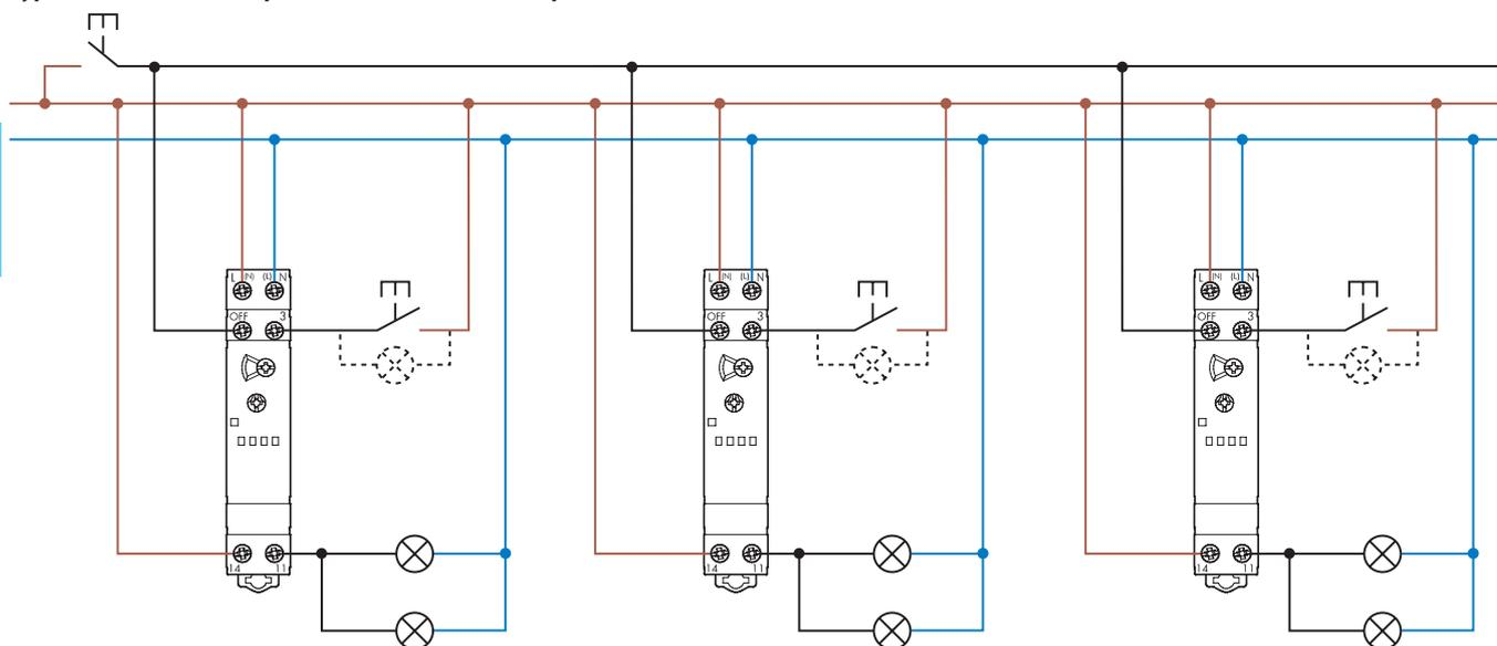
Schémas de raccordement (13.81, 13.91 et 13.21.8.230.B000)
