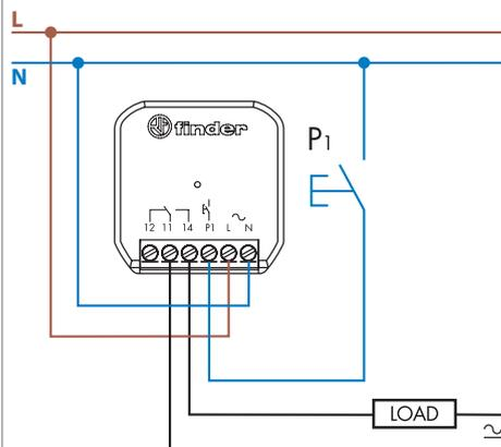
**Note :** si la charge est alimentée par une autre phase que celle d'alimentation du 13.21, une réduction de 50% de la puissance nominale doit être appliquée (régler la fonction "phase différente" depuis l'application Finder Toolbox Plus).
