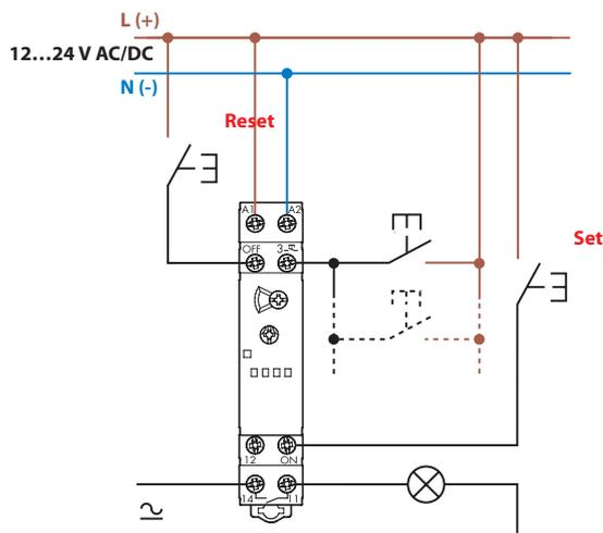
**Type 13.61.8.230 - Exemple de raccordements multiples 4 fils, avec extinction centralisée**
