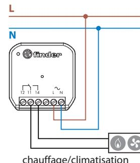
Exemple de raccordement avec une électrovanne 230 V AC, toujours se référer aux caractéristiques techniques du dispositif piloté.
