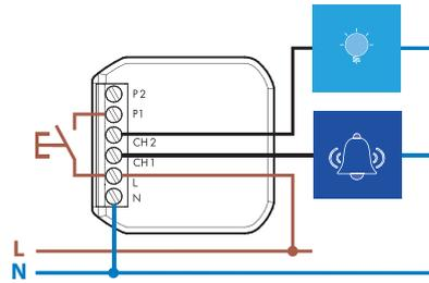
Type 13.22 - Fonction spéciale R1a - Télecoup (commande avec interrupteur).
