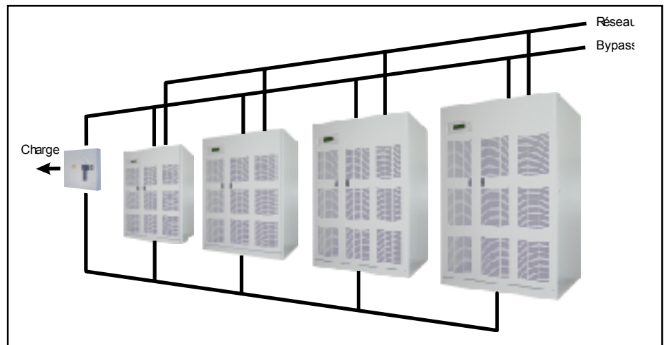
Exemple de configuration HotSync avec bypass de maintenance
