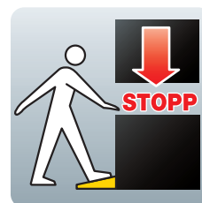
Surveillance de zones dangereuses ouvertes avec des tapis sensibles
