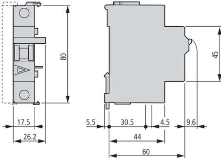
**Déclencheurs à émission de tension**
