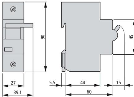
**Déclencheur à manque de tension**
