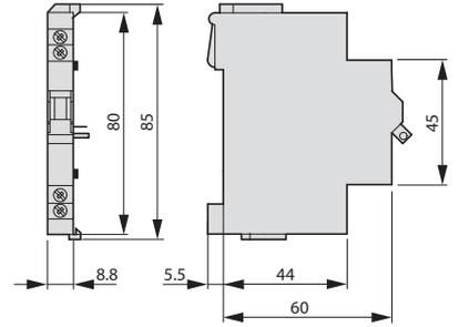
**Déclencheurs à émission de tension**
