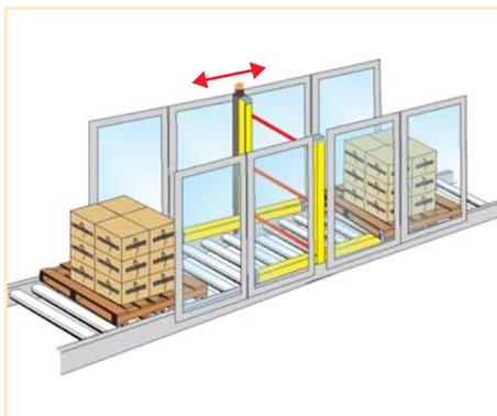
Version avec détecteurs de Muting intégrés en 'T' pour inhibition bidirectionnelle
