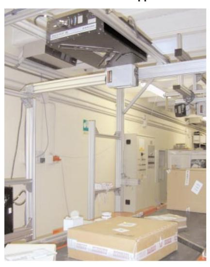
L'architecture optique du DX8200 permet une installation rapide de type "plug'n play" de votre système de lecture omnidirectionnelle. L'installation s'effectue facilement sur la partie supérieure ou latérale du convoyeur, offrant une lecture optimale dans des applications multifaces.
