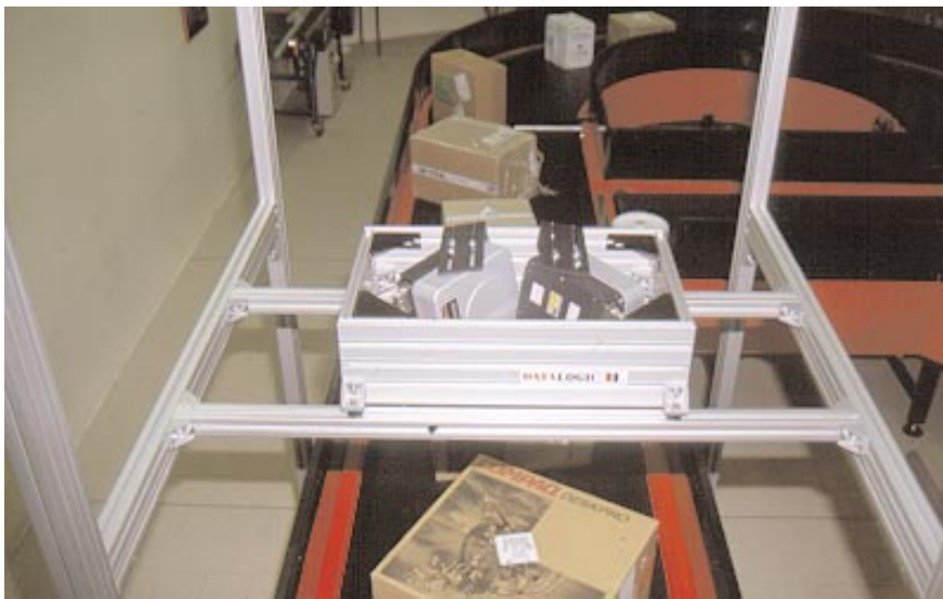
Station omni DS8100 simple croix de lecture sur la face du dessus
