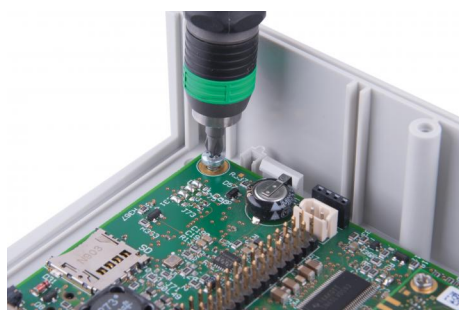
Montage de cartes C.I. dans la partie inférieure et supérieure
