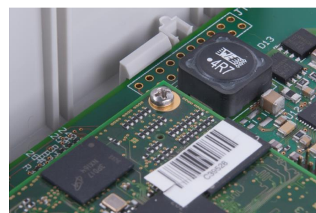
En fonction de la disposition, possibilité d'encliquetage sans vis des cartes C.I.
