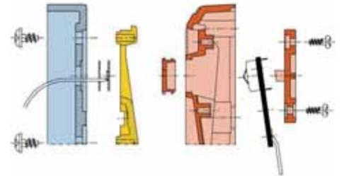
Principe de montage de la zone de contact.
