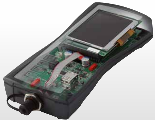
BOS-Streamline Afficheur associé à un clavier membrane spécifique au client.
