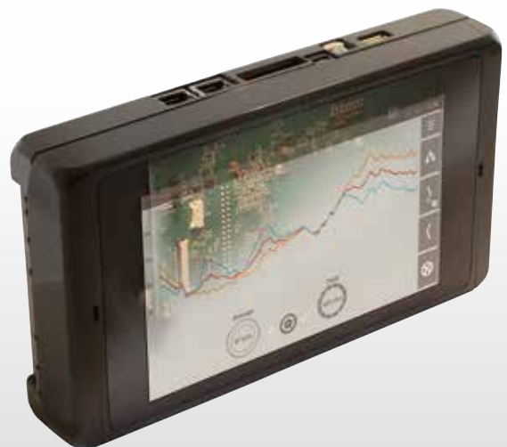
Bocube Avec impression au dos de la vitre, unité écran tactile / afficheur assemblée par collage optique + SBC.
