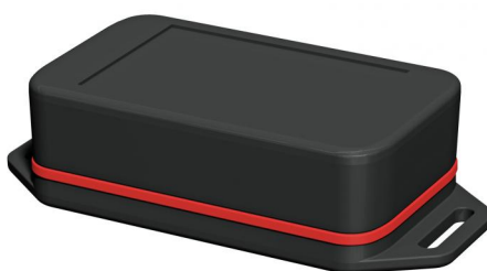
Type de protection IP 65 grâce au joint décoratif ; disponible en plusieurs couleurs. Ceci augmente d'env. 1,7 mm la hauteur de montage pour les pièces électroniques.
