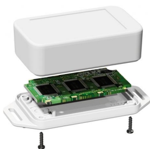
Un PCB de 1,6mm d'épaisseur peut être serré entre les 2 parties du boîtier ou en option directement entre 2 ergots thermos-collés.
