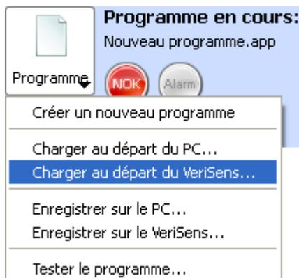
Ce point du menu sert à charger un programme enregistré auparavant dans le capteur de vision *VeriSens®* pour traitement dans *Application Suite*.
