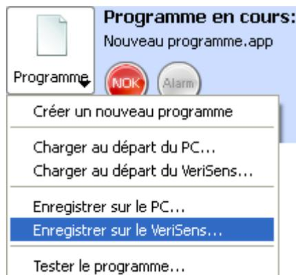
Ce point du menu sert à enregistrer un programme créé à l'aide d'*Application Suite* sur le capteur de vision VeriSens®.
