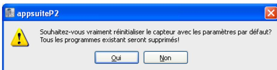
Confirmez par *Oui* pour remettre le capteur aux réglages d'usine.
