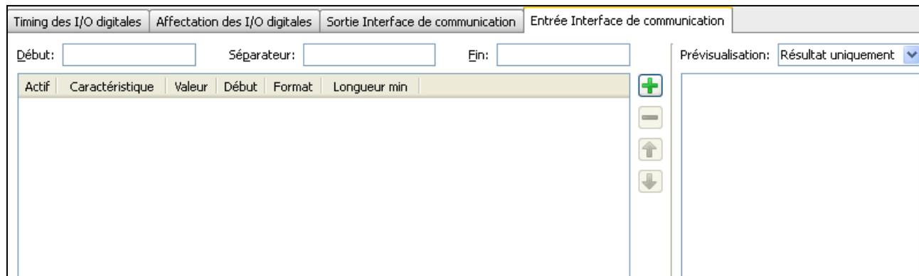
Il est possible, par voie de l'interface de processus, de définir les valeurs attendues de l'inspection des caractéristiques de l'identification, par exemple, à l'aide de la commande SP (Set Parameter)
