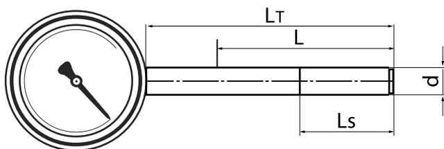
$L_s$  = Longueur d'immersion minimale du plongeur (mm)
