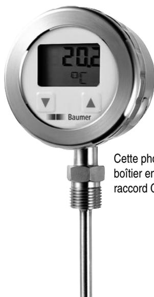
Cette photo montre le BattTemp monté sur le boîtier en acier inoxydable ø80 mm avec un raccord G1/2A et une sonde Pt100.
