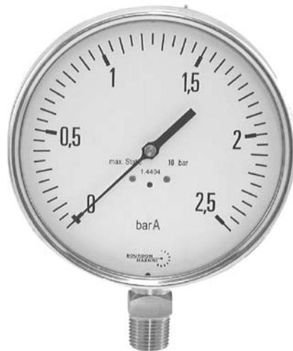
Le MA permet de mesurer des pressions absolues de 0,1 bar à 16 bar. Le soufflet basse pression dans lequel le vide a été réalisé sert de référence. Il résiste aux surpressions accidentelles.
