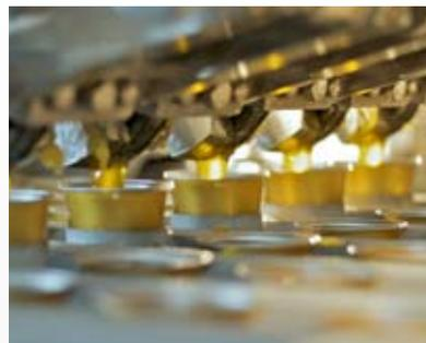
Sur les installations de remplissage, les pots de yaourt sont positionnés pour le processus de remplissage au moyen de détecteurs optiques. Les détecteurs répondent aux prescriptions d'hygiène de l'industrie agro-alimentaire et peuvent être facilement intégrés dans l'installation.
