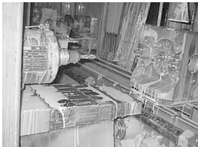
Conditions d'environnement très sévères : utilisation de réfrigérants, copeaux brûlants, charge mécanique ...
