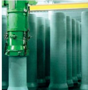
Machine pour la construction d'éléments en béton
