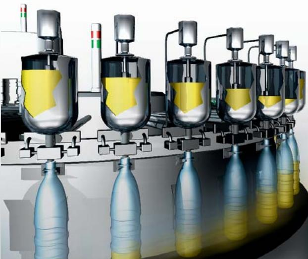
Contrôle du niveau de remplissage
