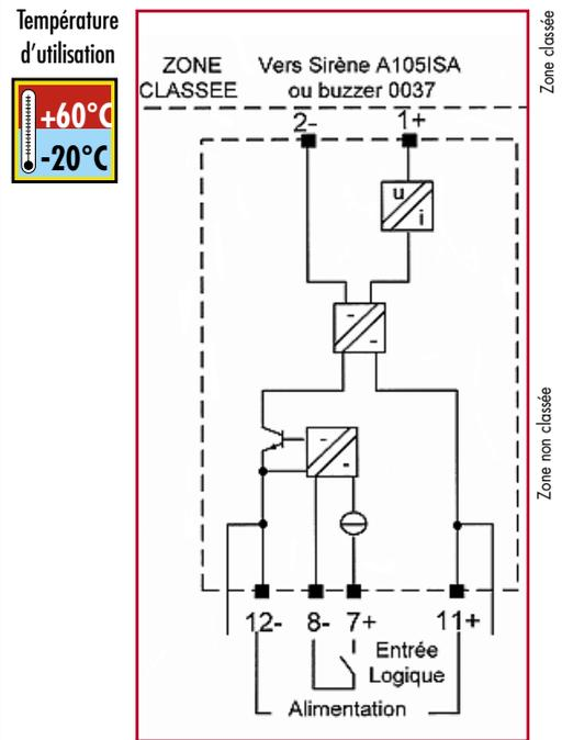
**Attention :** Dans le cas du raccordement de 2 sirènes A105 N IS sur un même amplificateur il y aura une perte de puissance sonore de 3 dB.
