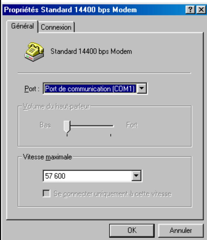
Dans la fenêtre propriétés il faut configurer la vitesse du port COM avec une vitesse maximale de 57600 Bits/s
