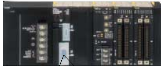
Connexion sur le port Host Link RS-232
